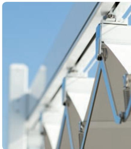
Il sistema di trasmissione è su guide laterali portanti tramite cinghia dentata ad alta resistenza, rotante su cuscinetti a sfera. Il carter è in fusione d'alluminio con regolazione di trazione delle cinghie. Profilo portante (70 x 130 mm) e frangitratta (40 x 50 mm) sono in alluminio, mentre le staffe sono in acciaio inox e le fusioni in alluminio verniciato.
